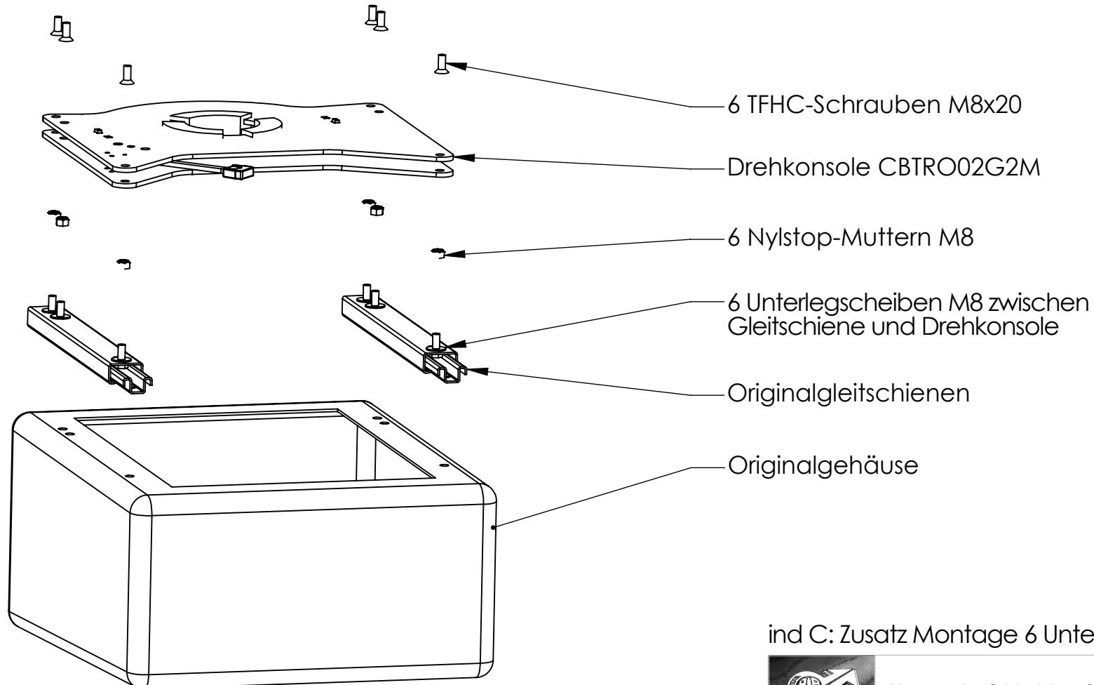
ind C: Zusatz Montage 6 Unterlegscheiben M8
