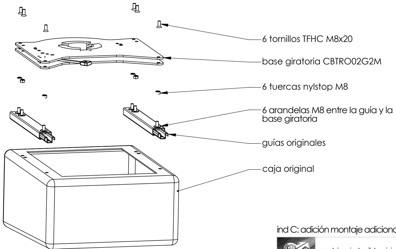
ind C: adición montaje adicional 6 arandelas M8
