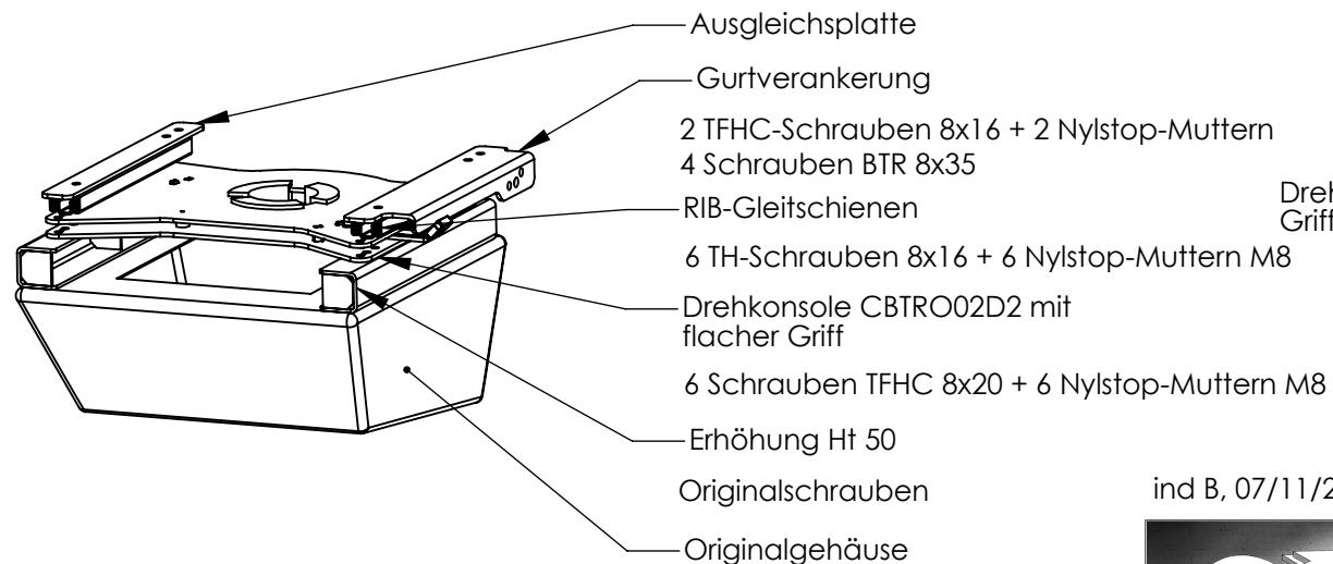
Drehkonsole CBTRO02D2 mit flachem Griff, um 20 mm gekürzt.
